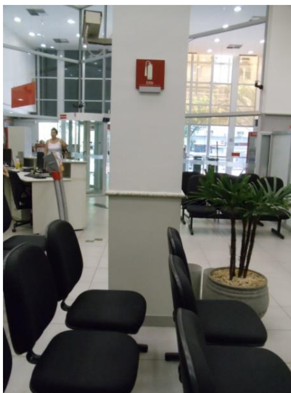
Figura 39 – Placa de Sinalização de extintor incorreta e falta de indicação de rota de fuga (Fonte: Arquivo Pessoal, 2014)
