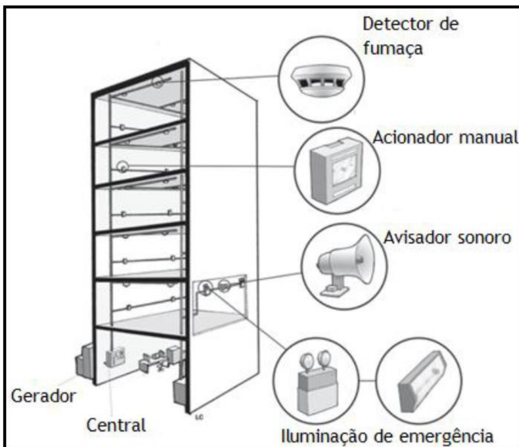
Figura 12 – Sistema de detecção e alarme de incêndio e de iluminação de emergência.
