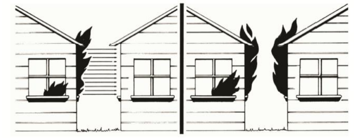
Figura 6 – Formas de propagação do fogo por radiação.
